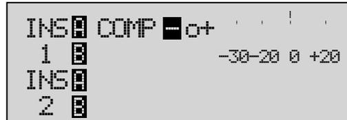
Diese Seite zeigt die Gain-Verringerung von Dynamic-Blöcken an, die in den Insert 1 oder Insert 2 Blöcken konfiguriert wurden.
