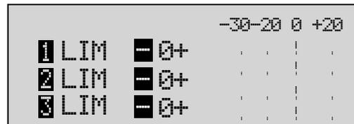
Diese und die folgende Seite zeigen die Gain-Verringerung an den Ausgängen 1 - 6 des Limiter-Moduls an.
