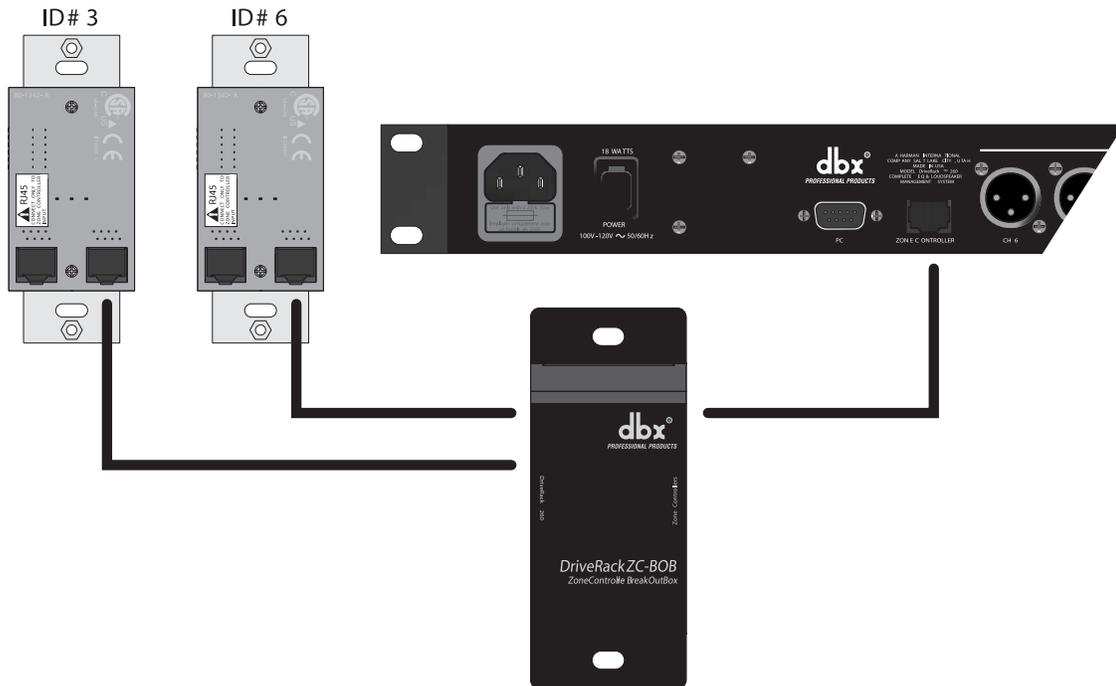
Kabel-Spezifikation: Cat 5 Kabel - 4-Twisted Pairs von 24 AWG Draht
